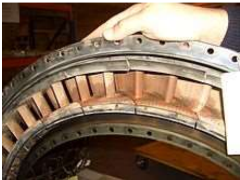
Primo stadio statorico della turbina di alta pressione di un motore CFM56-3.
