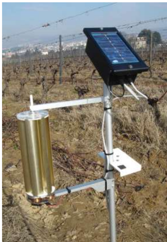
Figura 43 - Nodo di misura in una rete wireless di monitoraggio delle colture. Si notano generatore eolico e pannello solare.
