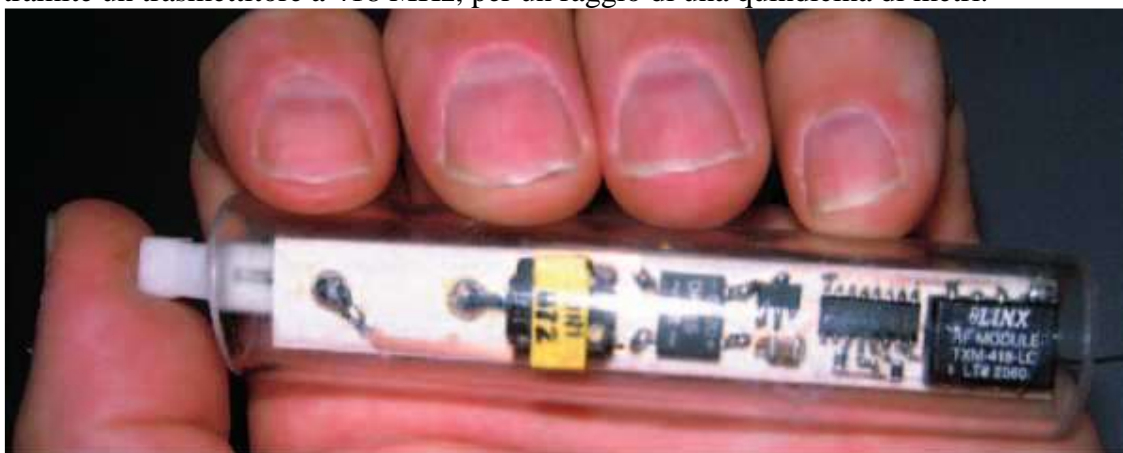
Figura 42 - Telecomando wireless autoalimentato dalla pressione del pulsante
