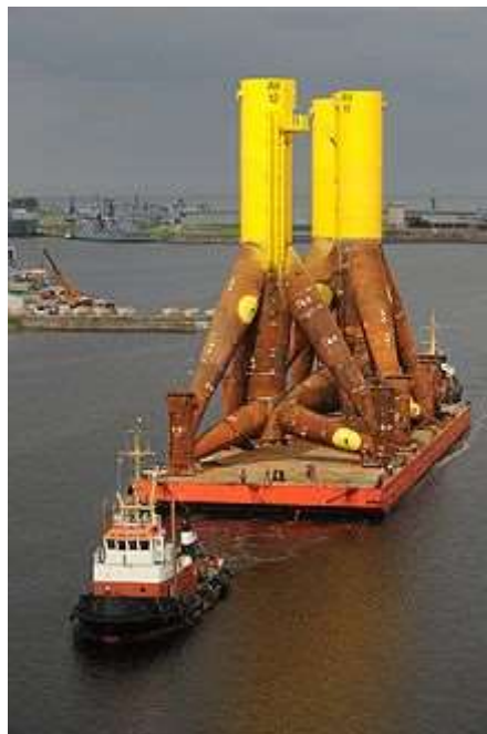
Fondazione treppiedi per parchi eolici offshore nel 2008 a Wilhelmshaven, Germania.
