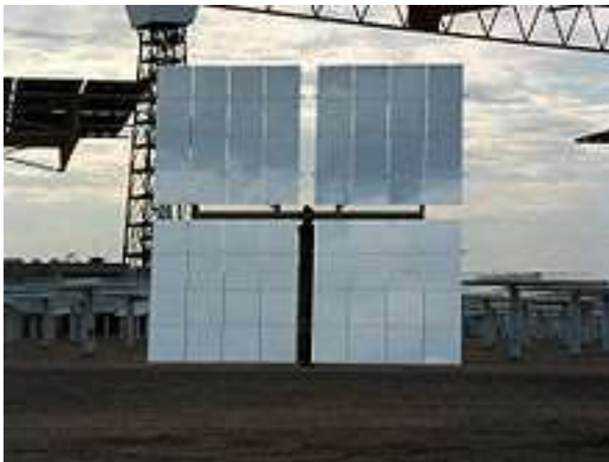
Uno degli eliostati del Solar Two fotografato nel 2003 con la torre centrale visibile sullo sfondo.
