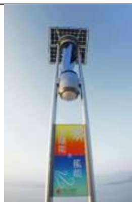
Una lampada eolico - fotovoltaica ad Hong Kong
