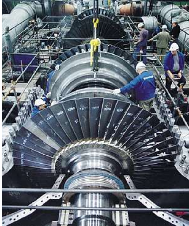
Montaggio di una turbina a vapore Siemens.
