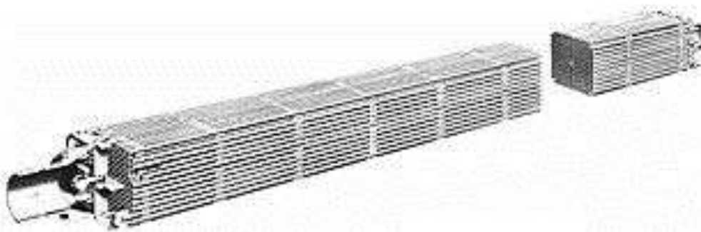
Elemento di combustibile: assemblaggio di barre in reticolo quadrato 17x17
