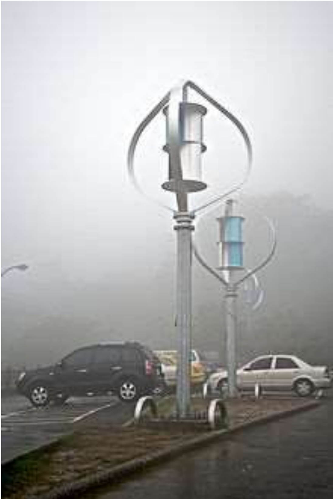
Una turbina a vento di Savonius, combinata con una turbina Darrieus, installata a Taiwan.
