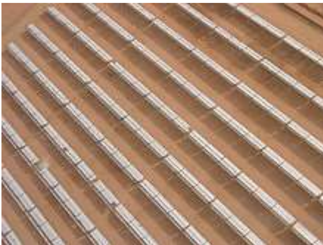
Veduta aerea ravvicinata: si notino alcuni eliostati infranti dalla forza del vento
