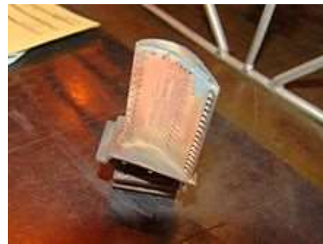
Una paletta di un primo stadio di turbina. Si notino i fori per il raffreddamento sul bordo d'attacco, ventre e bordo d'uscita.
