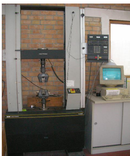
Dinamometro per prove di trazione ISO 527
