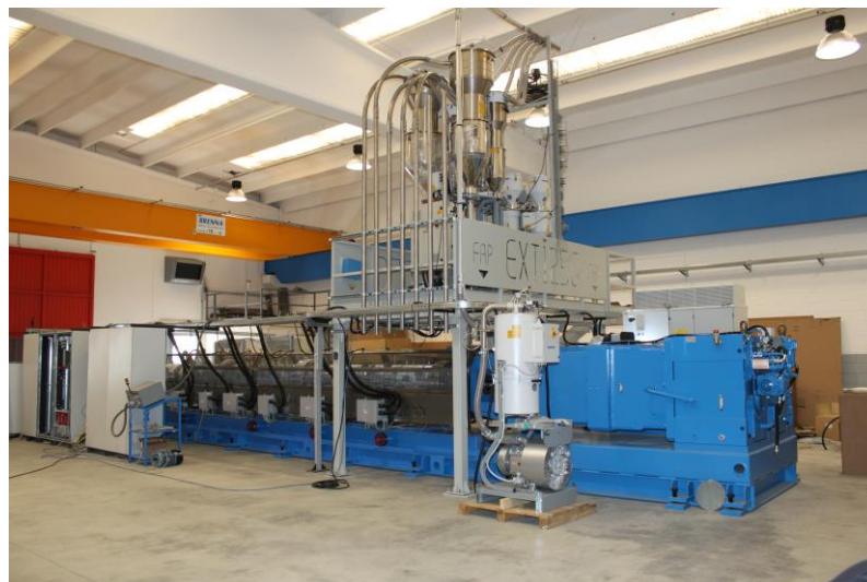
Vista parziale di un impianto di estrusione per pannelli espansi (FAP S.r.l.)
