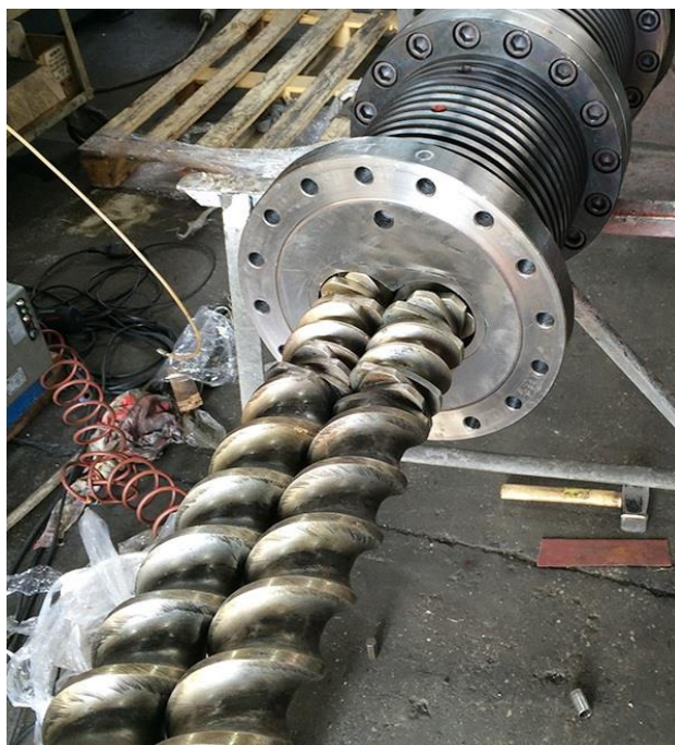
Coppia di viti corotanti estratte del cilindro
