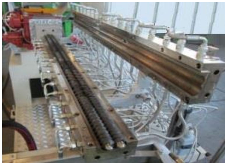
Cilindro per estrusore bivate in due metà aperto. (AMUT S.p.A.)
