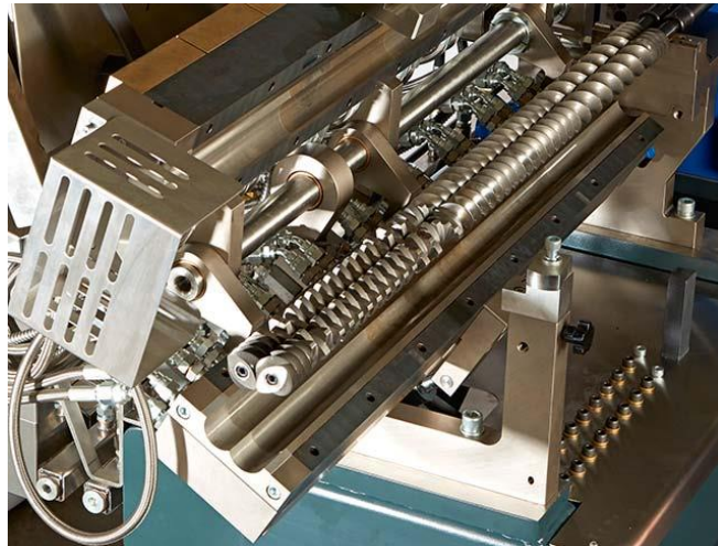
Estrusore bivate da laboratorio con cilindro apribile in due parti
