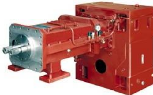
Riduttore per estrusore bivite (Zambello Riduttori S.r.l.)
