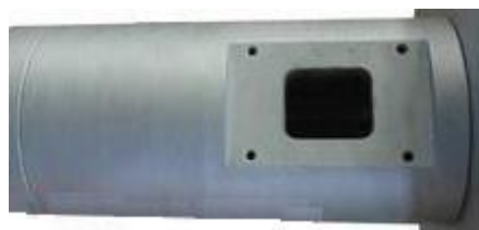
Dettaglio finestra alimentazione bocchetta
