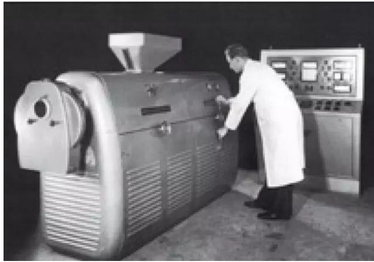
Primo estrusore bivate WP per miscelazione di polimeri (anni '50)
