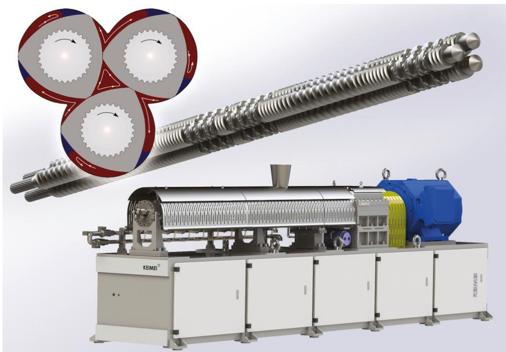
Estrusore a tre viti KMDPlastifizierungstechnik GmbH per compounding
