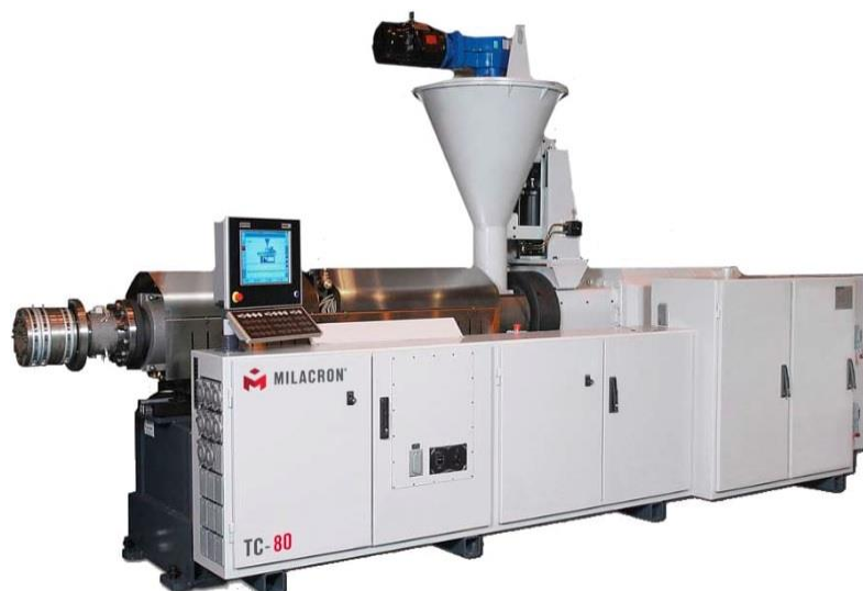
Estrusore bivate controrotante a viti coniche. (Milacron)
