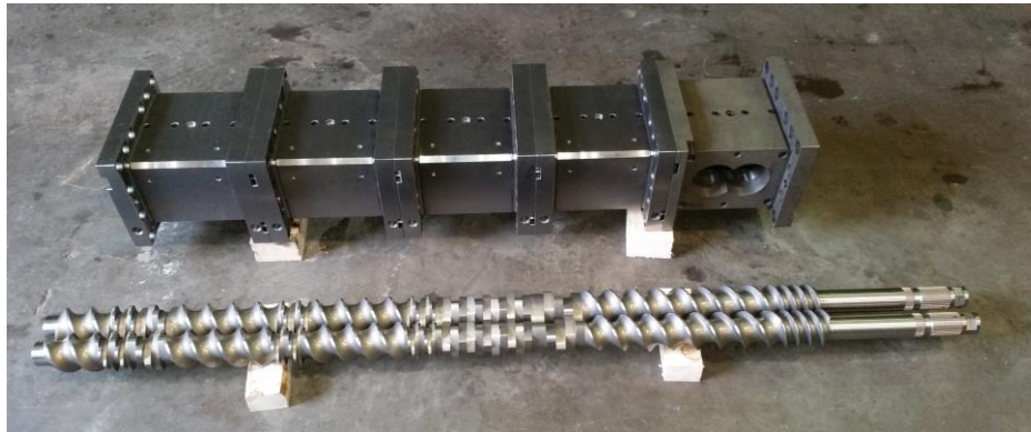
Cilindro bivate componibile con le sue viti di estrusione. (Euroviti S.r.l.)
