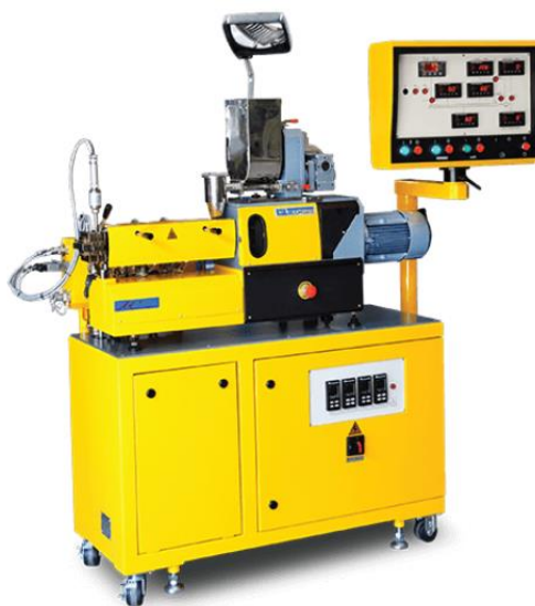
Estrusore bivate da laboratorio (Labtech GmbH)
