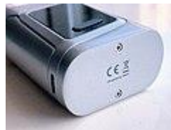
Simbolo CE e del simbolo RAEE su un dispositivo elettronico (sigaretta elettronica).
